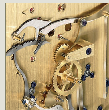
Besonders ansprechend sind die konischen Stahlstifte und die Stein- und Kugellager des Uhrwerks.
